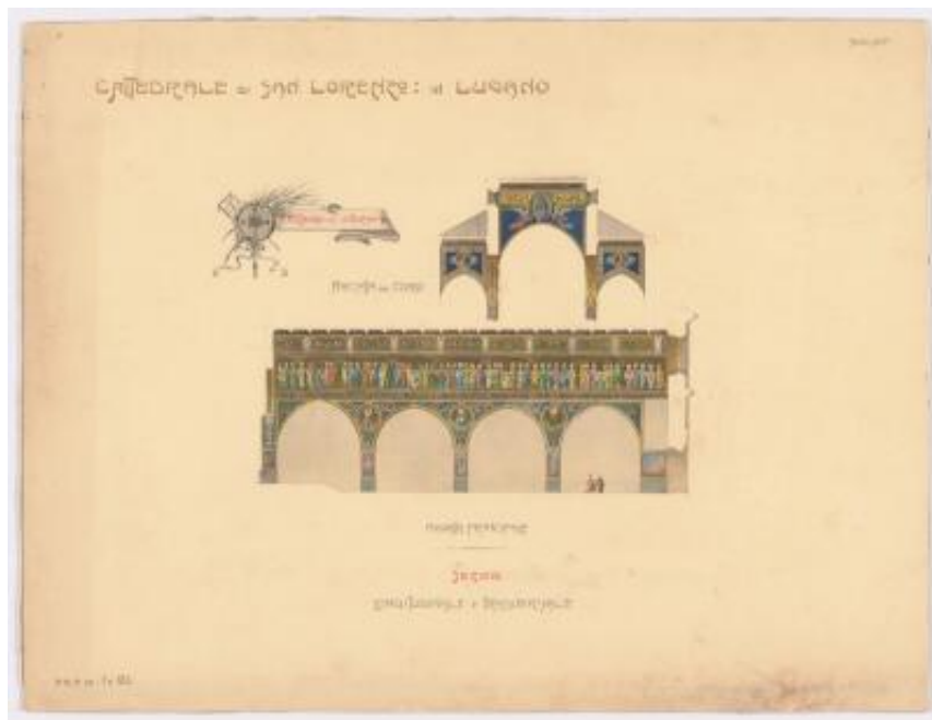
Cattedrale di S. Lorenzo in Lugano. Restauro dell'interno. Arcata del coro, navata principale, sezioni longitudinale e trasversale
