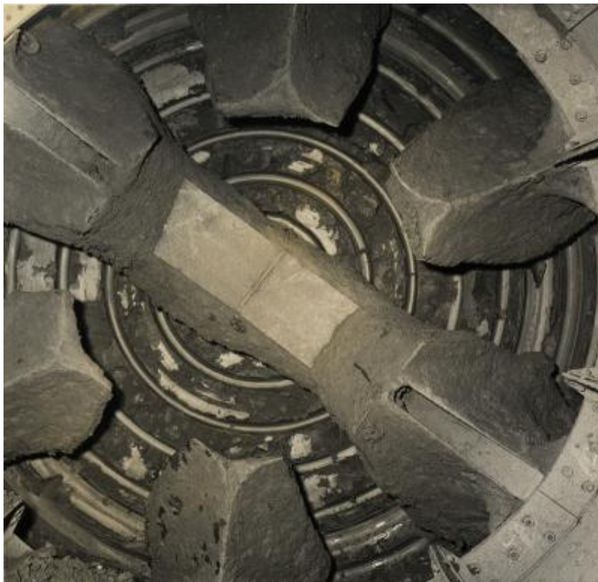
Vista del lato operativo della fresa a tamburo dall'interno del cilindro
